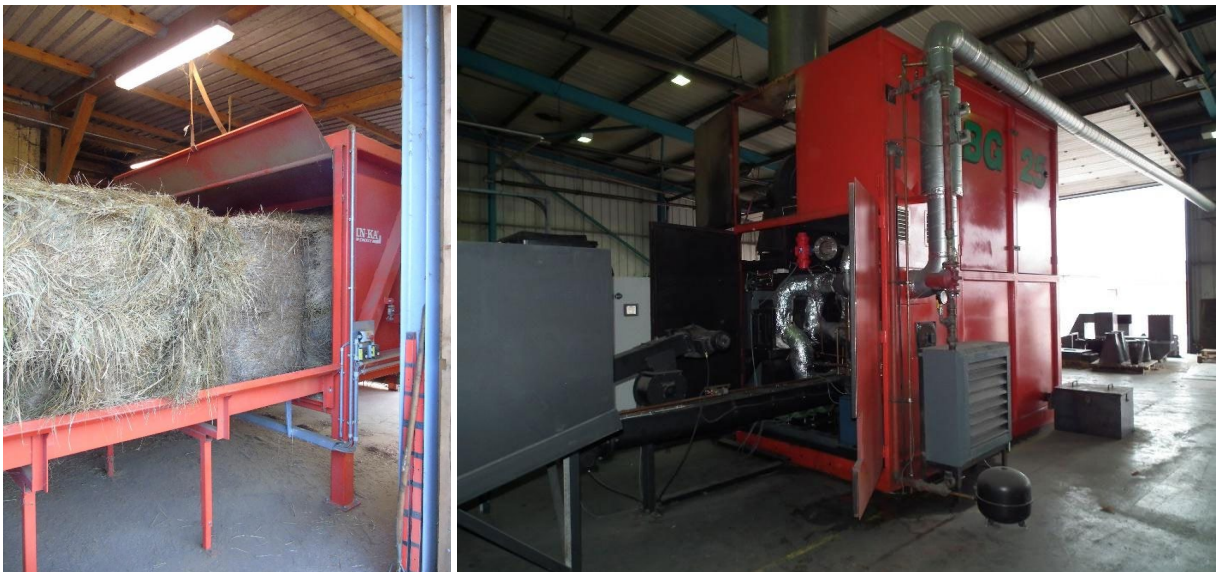
Žemės ūkio biomasės ritinių deginimas, prieš tai juos susmulkinus. Brandenburg, Vokietija. Lukasz Mucha nuotr.
