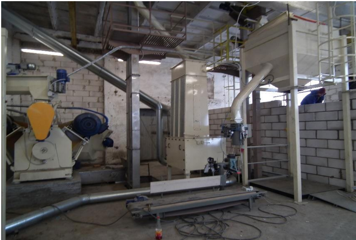
OTOP priklausanti granulių gamybos linija, kuriai biomasė buvo tiekama iš šlapių žemapelkinių pievų. Podlaskie vaivadija, Lenkija. Łukasz Mucha nuotr.
