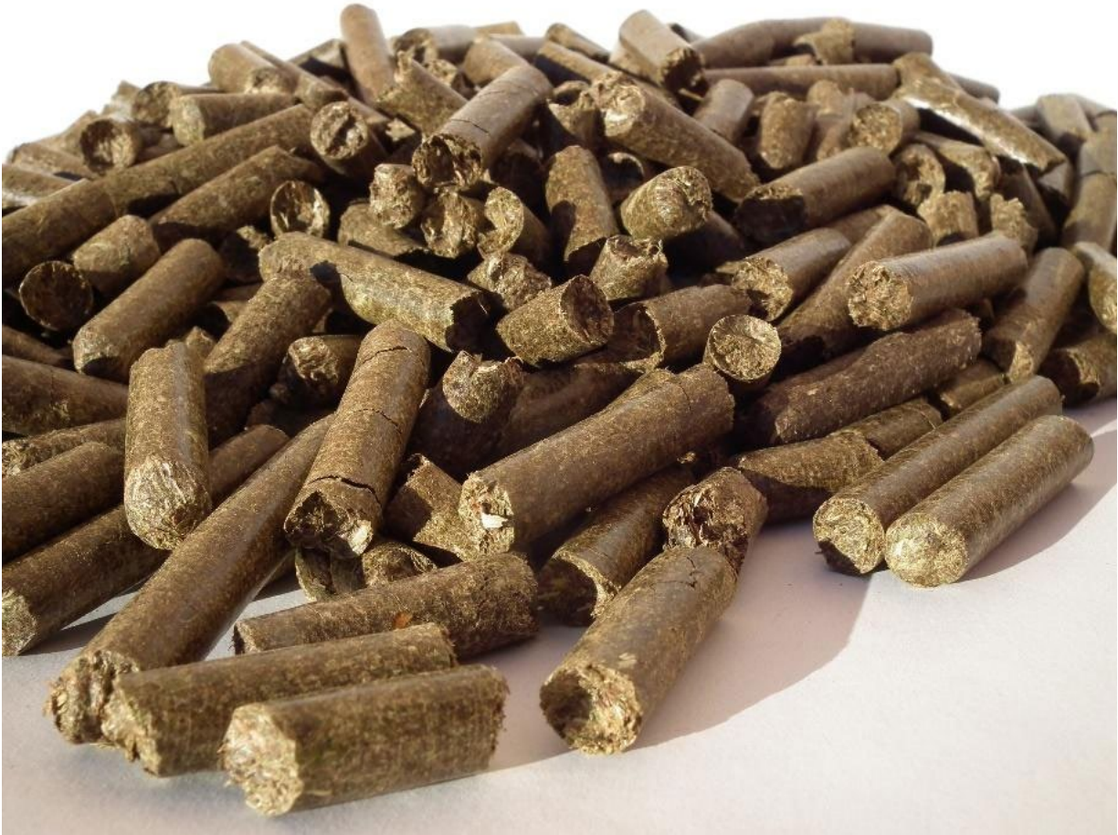
OTOP granulės, pagamintos iš biomasės, gautos iš pusiau natūralių pelkinių buveinių. Lukasz Mucha nuotr.
